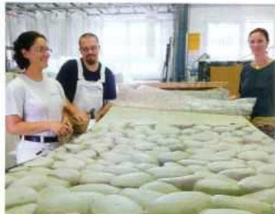
Tonmodell der Eierkohlenstruktur als Vorlage für die Matritzenherstellung.
